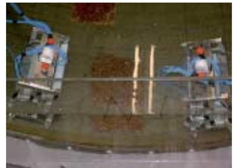
Ultraschall-Sensorsystem zur Vermessung von Fehlstellen in Abwasserkanälen.
