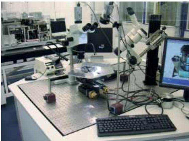
Abbildung 4: Prototypenevaluation zur Manipulation von Zellen auf magnetischen Trägern (MagnaLab).
