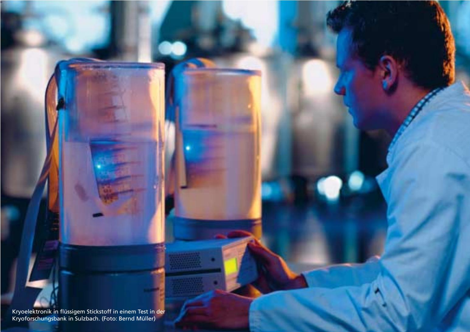
Kryoelektronik in flüssigem Stickstoff in einem Test in der Kryoforschungsbank in Sulzbach. (Foto: Bernd Müller)
