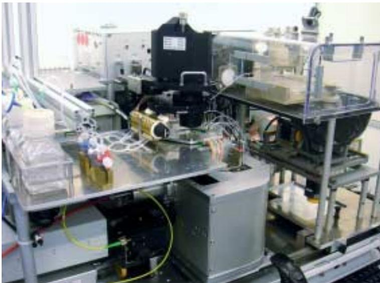
Abbildung 3: Integration der Module um den NazcaLab-Chip.
