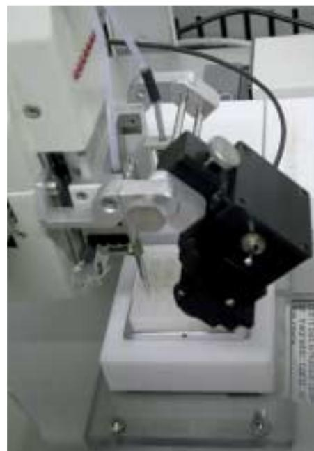
Abbildung 2: Nanoplotter (GeSIM mbH) beim Befüllen eines Kryosubstrates mit 30 x 25 µl Inhalt. Die Zugabe von Kryoprotektiva wie Glycerin oder DMSO kann picolitergenau gesteuert werden.
