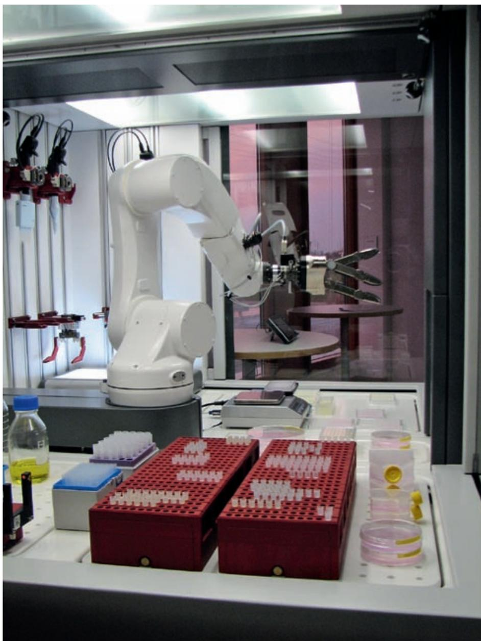
Abbildung 1: Werkzeugwechsel: Der Roboterarm bewegt sich zu einer Pipettenaufnahme-Position.
