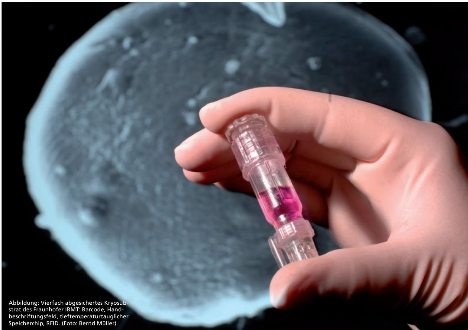
Abbildung: Vierfach abgesichertes Kryosubstrat des Fraunhofer IBMT: Barcode, Handbeschriftungsfeld, tieftemperaturtauglicher Speicherchip, RFID. (Foto: Bernd Müller)
