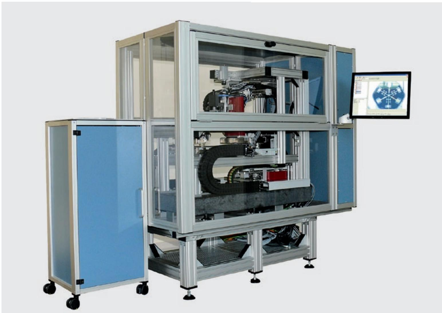
Abbildung: Die zentralen Komponenten des MagnaLab sind in einem vollautomatisierten System integriert und erlauben die autonome In-vitro-Zellkultur und -differenzierung über mehrere Wochen.
