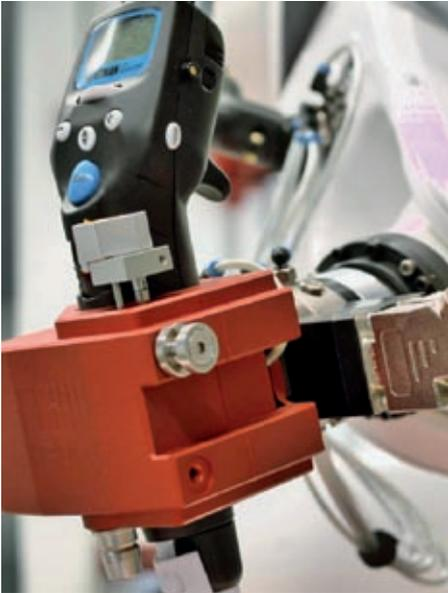
Abbildung 4: Aufnahmemodul für Standard-Pipetten mit direkter Programmierung und Ansteuerung der Pipetten einschließlich pneumatischem Abwurf der Pipettenspitzen.
