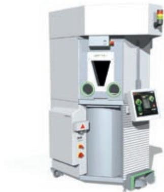
Teilautomatisiertes Hochsicherheitskryolagersystem (Askion GmbH, [www.askion.com](http://www.askion.com)). Das Lagersystem erlaubt die automatische Inventur bei Verwendung von »intelligenten« Probenröhrchen, das Ein- und Auslagern von Proben ohne Eintrag von Luftfeuchte und garantiert die geschlossene Kühlkette über die gesamte Lebenszeit der Proben.
