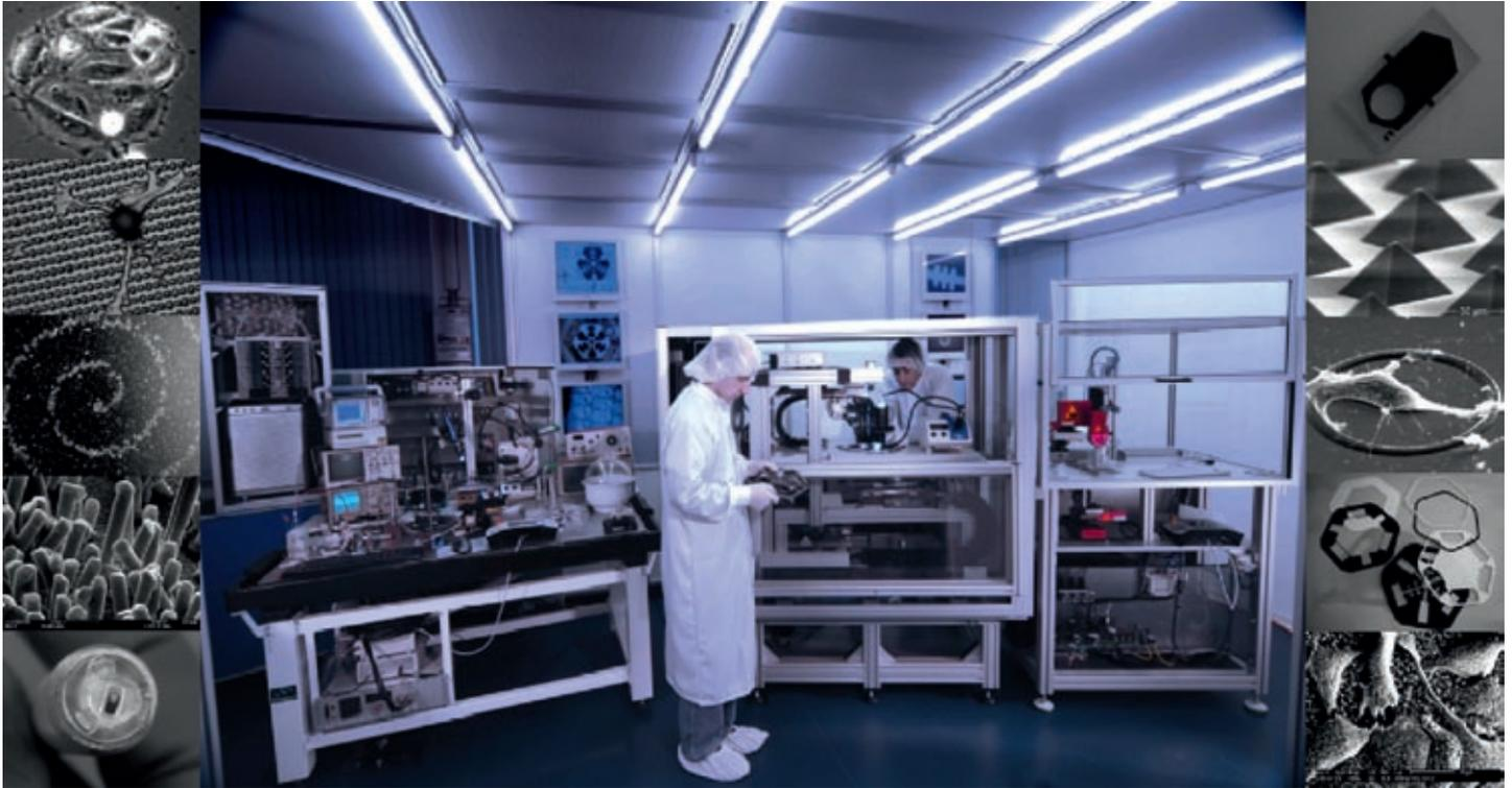
Abbildung 2: In-vitro-Zellautomat »Magna-Lab« zur Stammzellendifferenzierung auf magnetischen Mikrocarriern und hochparallelen Kultivierung von Zellen auf nanostrukturieren und funktionalisierten Oberflächen bis zu 20 Tagen und mehr.
