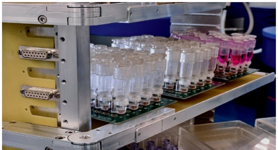
Rack-Plattform mit mehrfach abgesicherten Kryoprobenröhrchen auf Platine.
