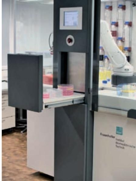
Abbildung 5: Ein Teil der eingehausten Arbeitsfläche wird durch ein Schubladenelement herausgefahren, eine Beschickung ist ohne Arbeitsunterbrechung wegen Eingriffs in den Sicherheitsbereich möglich.
