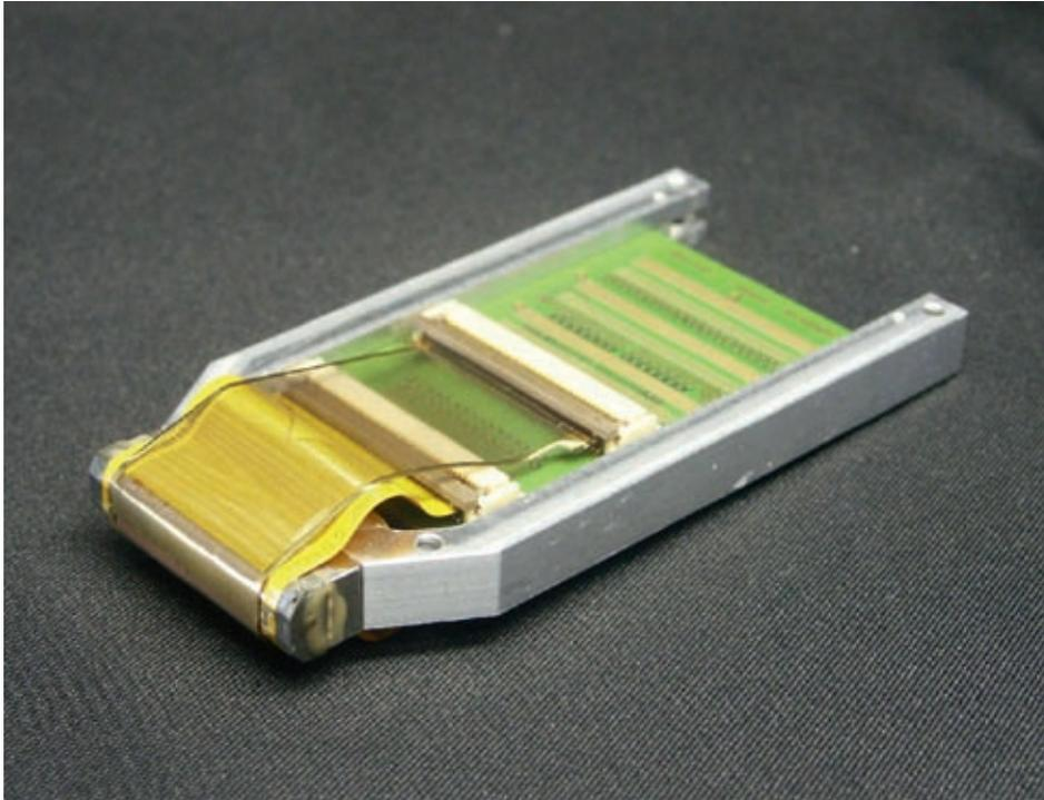
Abbildung 1: Miniaturisierter Multielementwandler (Array) in Sandwich-Bauweise für die medizinische Bildgebung. Die Baugruppe besteht aus einer Vielzahl von Ultraschallsensoren. Diese sind einzeln elektrisch kontaktiert und werden zu unterschiedlichen Zeitpunkten angeregt. Damit können Schallstrahlen geformt werden, die das Gewebe in Linien abtasten.
