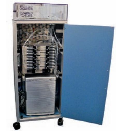
Abbildung 4: Fluidische Einheit mit zwei Spritzenpumpenmodulen (je 6 Spritzenpumpen), fluidischen Schaltventilen mit elektronischer Steuerung und einer Kühlkammer.
