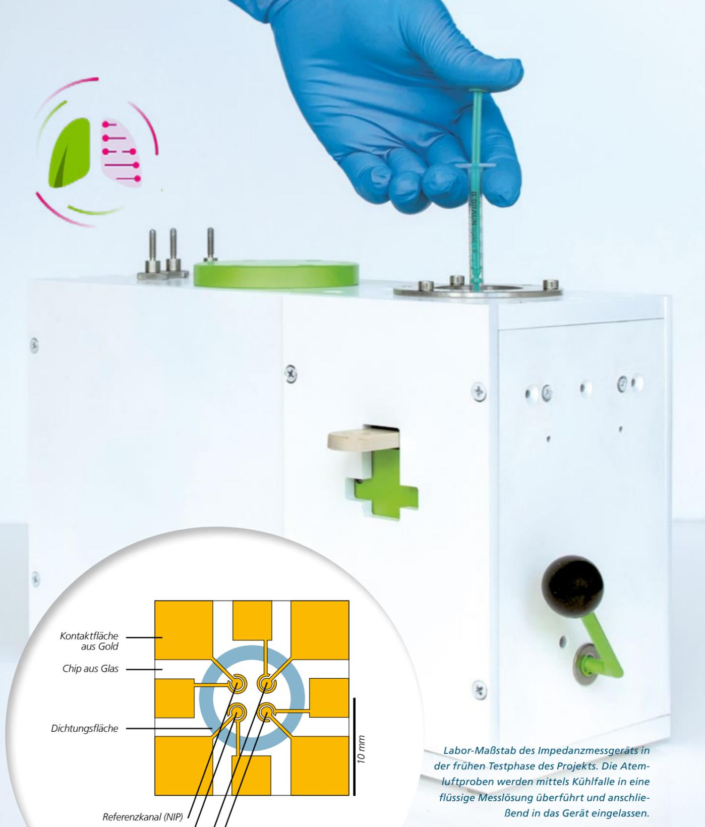
Labor-Maßstab des Impedanzmessgeräts in der frühen Testphase des Projekts. Die Atemluftproben werden mittels Kühlfalle in eine flüssige Messlösung überführt und anschließend in das Gerät eingelassen.
